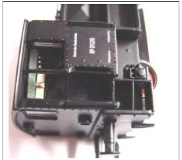
6) **Rechts:** Die Ansicht mit eingebautem Decoder von der anderen Seite des Führerstandes
