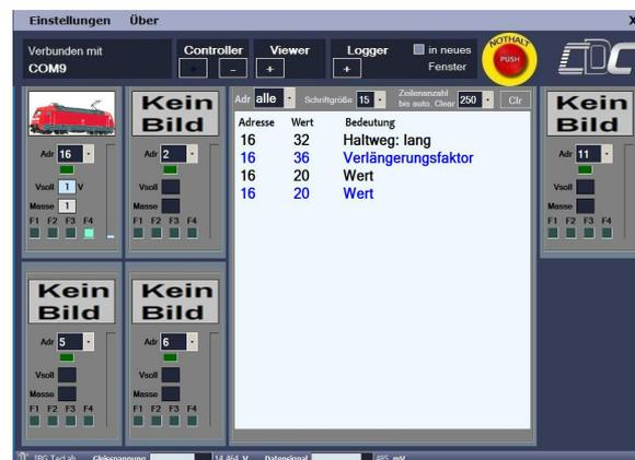
Am Beispiel im rechten Bild wurde bei Lok mit Adresse 16 zunächst ein langer Anhalteweg „Haltweg lang“ eingestellt (s. Beschreibung Lokdecoder Code 32, Register A1). Anschließend wurde der Code für den Verlängerungsfaktor 36 (s. Beschreibung Lokdecoder Register C1) eingegeben. Der nachfolgende Wert 20
