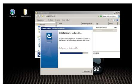
Die für das Interface erforderlichen FTDI Treiber befinden sich im gelieferten Programmpaket und werden nach dem Klick auf „extract“ automatisch mit installiert. Eine erforderlichenfalls manuelle Installation dieser Treiber ist in Kap. 4.3 beschrieben. Die Installation wird nun entsprechend der folgenden Bilder durchlaufen.
