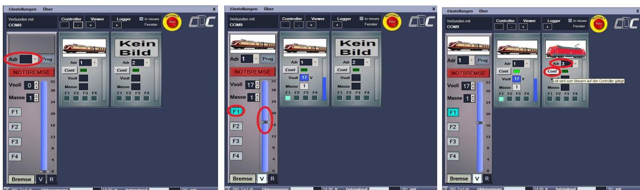
Im Bild links wird die Lok mit Adresse 1 gesteuert. Sie fährt vorwärts mit Geschwindigkeitsstufe 17 und die Zusatzfunktion F1 ist eingeschaltet. Entsprechend reagiert die Anzeige im Viewer-Feld der Lok 1. Rechts wurde im zweiten Viewer-Feld die Lok, Adresse 3 eingestellt. Ein Klick auf den Button „Cont“ übernimmt diese dann ins Controllerfenster, sodass die Lok sofort zur Steuerung durch den PC zur Verfügung steht.
