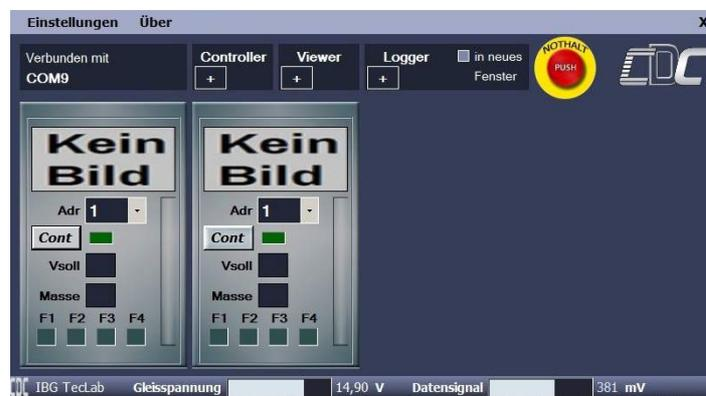
Das geladene Programm beginnt mit dem Viewer und zeigt zwei Viewer-Felder, jeweils mit der Lokadresse 1 im Feld „Adr“ an. Bei einer bestehenden Interface-Verbindung zur C-Digital Zentrale bzw. zur Gleisanlage wird unten die Gleisspannung mit dem Pegel des Datensignals und links oben im Feld „Verbunden mit“ die Verbindung PC-Interface als COM-Port angezeigt. Nach dem erstmaligen Laden des Programms befinden sich noch keine Referenzbilder in der Anzeige, es erscheint „Kein Bild“.
