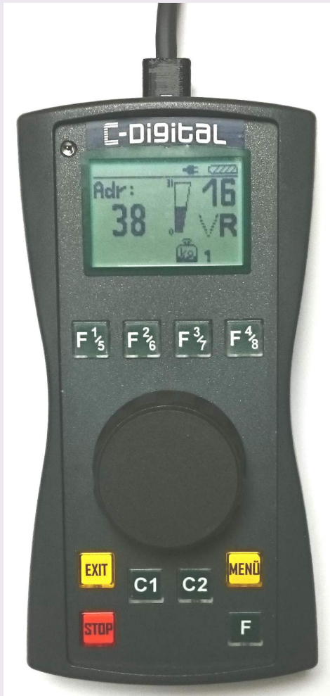
HRX20K Betrieb an der C-Digital Zentrale
